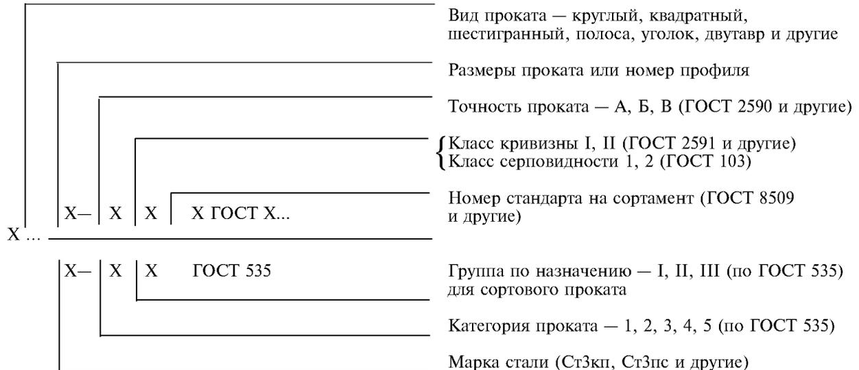
Прокат горячекатаный круглый диаметром 30 мм обычной точности прокатки (В), II класса кривизны, по ГОСТ 2590 марки Ст5пс, категории I, группы II:
